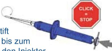
3. Ziehen Sie den Stift langsam aus dem Injektor. Der Kapselspannung ist nun „geladen“.
